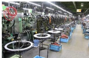
では、単純であることで、どのようなメリットがもたらされるのか——。例えば機械操作が容易、小型で単純な構造の金型にて対応可能、低イニシャルコストなどなど……。実はこのハトメ方式、コストダウンに不可欠な要素を多数兼ね備える、合理的な生産設備!なのです。
